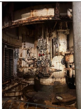
Действующая система подъёма пушек на поверхность и их спуска в каземат
